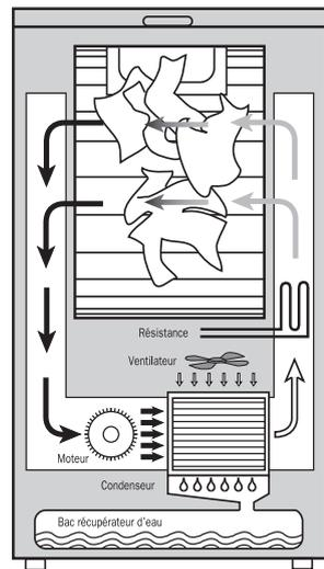
L'air chauffé absorbe l'humidité du linge. La vapeur d'eau condensée dans le sèche-linge est récupérée dans le bac mobile.
