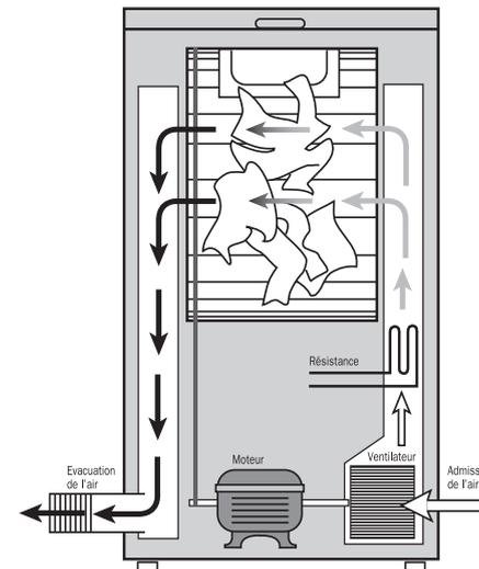
L'air chauffé absorbe l'humidité du linge. La vapeur d'eau produite est rejetée à l'extérieur par le système d'évacuation.
